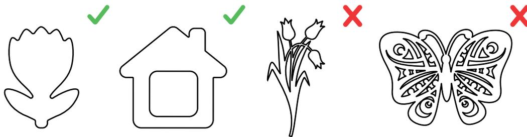
Cuando el troquelado se hace mediante fresado no podremos ofrecer cortes por un tamaño inferior a 3 mm:
