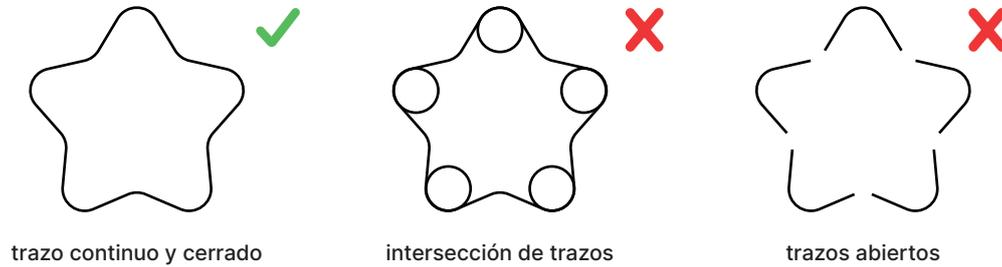
En soportes rígidos de gran formato el troquel no ofrece tanta definición y detalle como el troquelado láser, por lo que no recomendamos piezas con mucho detalle y/o elementos con poco grosor que penden de la pieza:
